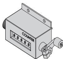
Механический счетчик циклов предназначен для указания количества циклов включения/отключения. Унифицирован для выключателей "YON" AD габаритного исполнения S2, S4, S6. Устанавливается под лицевой панелью автоматического выключателя в собственную ячейку.
