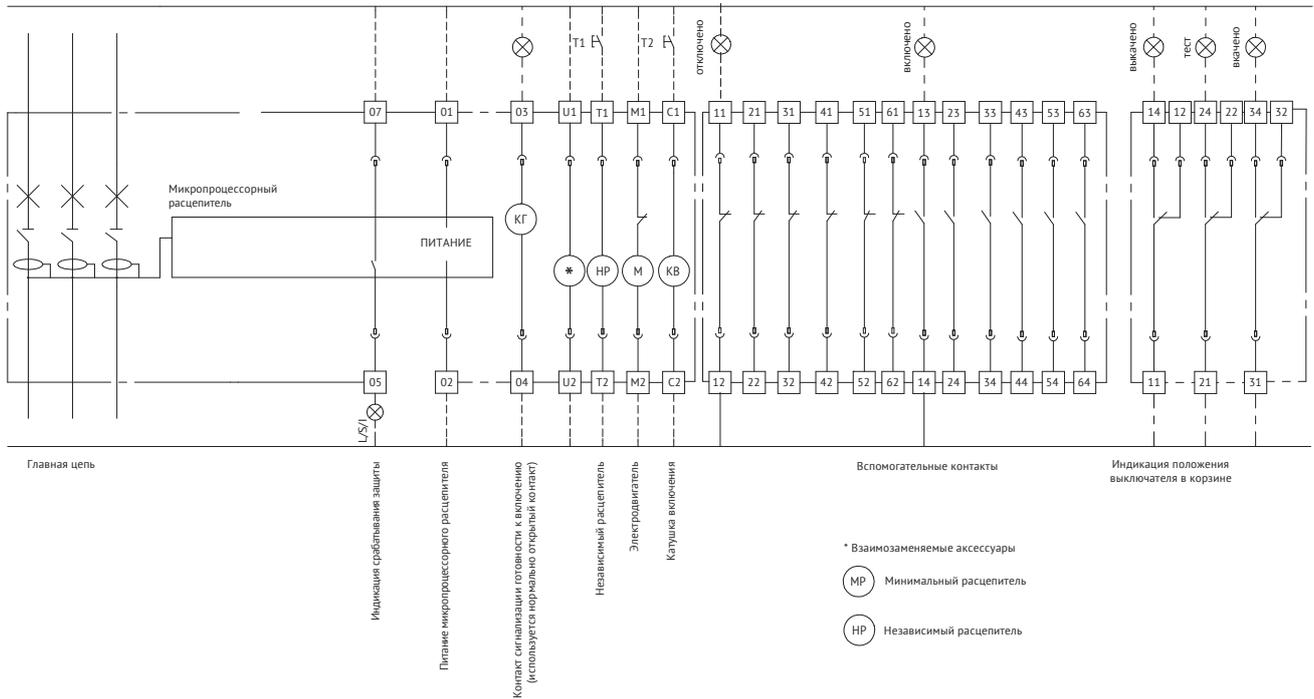
Принципиальная электрическая схема выключателя с полупроводниковым расцепителем типа MR7.0 габаритного исполнения S2, S4, S6
