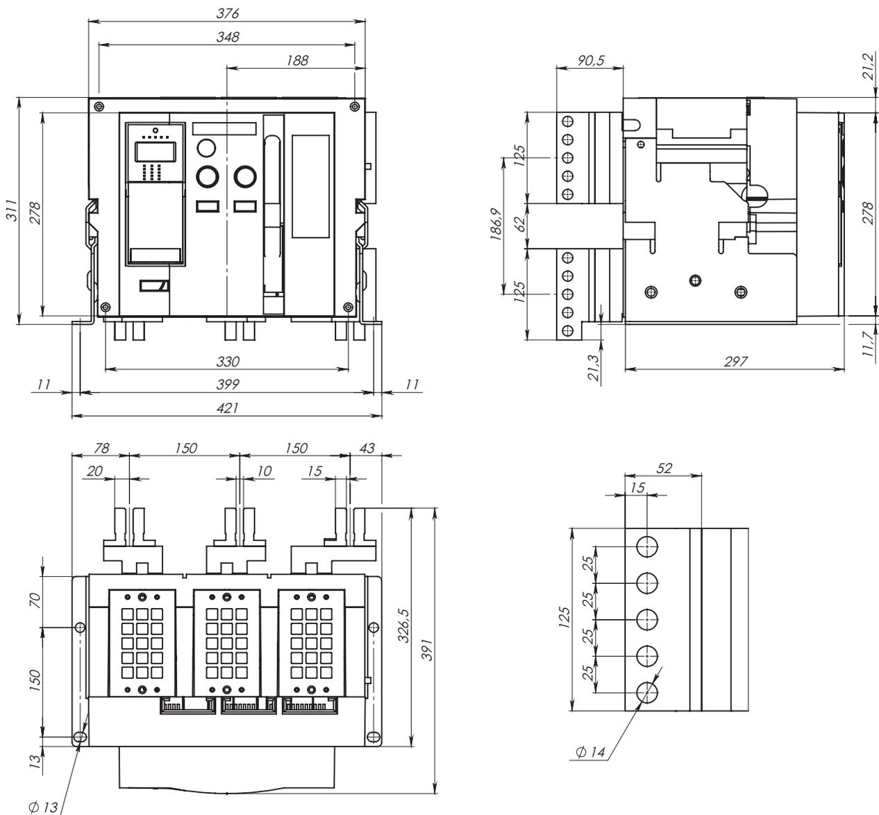
Автоматический выключатель "YON" AD-630-1600-S1-3P выдвигного исполнения на номинальные токи 630-1600 А с задним горизонтальным расположением выводов
