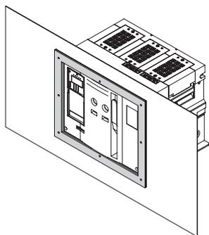
Рамка передней панели предназначена для защиты от прикосновения к острой кромке выреза. Кроме того, она защищает выступающую переднюю часть выключателя. Устанавливается на переднюю панель распределительного устройства.
