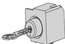
Встраиваемый замок включения предназначен для блокировки включения (блокирует выключатель в отключенном состоянии). Разблокировать выключатель без соответствующего ключа невозможно. Устройство унифицировано для выключателей "YON" AD габаритного исполнения S2, S4, S6. Устанавливается под лицевой панелью автоматического выключателя в собственную ячейку.
