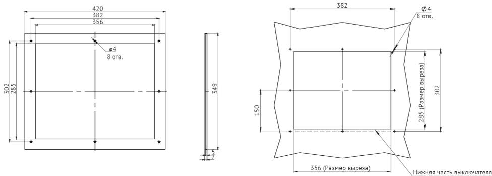
Рамка передней панели стационарного "YON" AD габаритного размера S4 на токи от 2500 до 4000 А
