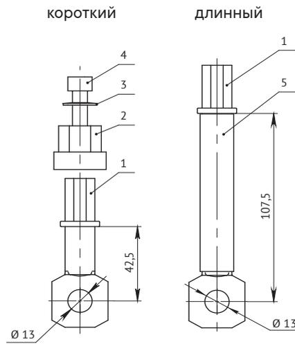
1 - вывод; 2 - переходная деталь; 3 - пружина тарельчатая;
