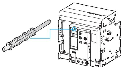
Модуль в основании микропроцессорного расцепителя оснащен кнопкой ручного возврата в исходное состояние после срабатывания от микропроцессорного расцепителя. При срабатывании автоматического выключателя кнопка выдвигается вперед. Для включения автоматического выключателя необходимо нажать кнопку. Унифицирован для выключателей "YON" AD габаритного исполнения S2, S4, S6. Устанавливается под лицевой панелью автоматического выключателя в собственную ячейку. Входит в базовую комплектацию.
