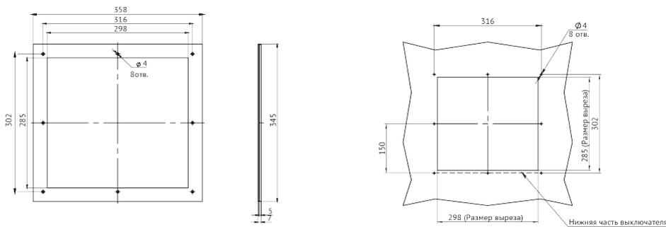
Рамка передней панели стационарного "YON" AD габаритного размера S2 на токи от 630 до 2000 А
