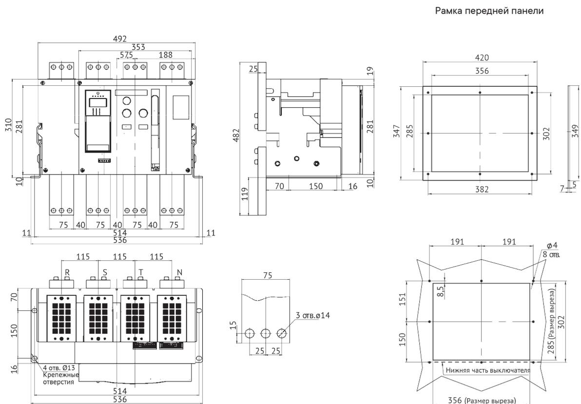
Автоматический выключатель YON AD-4000-S4-3P стационарного исполнения на номинальный ток 4000 А с задним вертикальным расположением выводов
