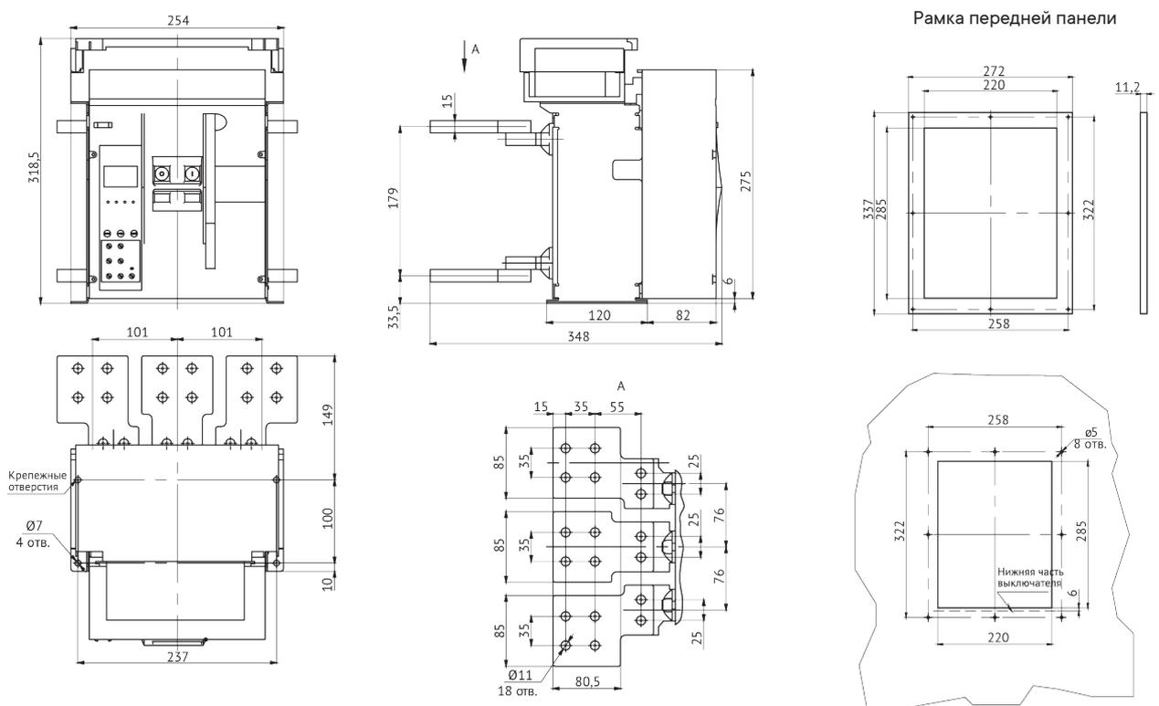
Автоматический выключатель "YON" AD-630-1600-S1-3P стационарного исполнения на номинальные токи 630-1600 А с задним вертикальным расположением выводов
