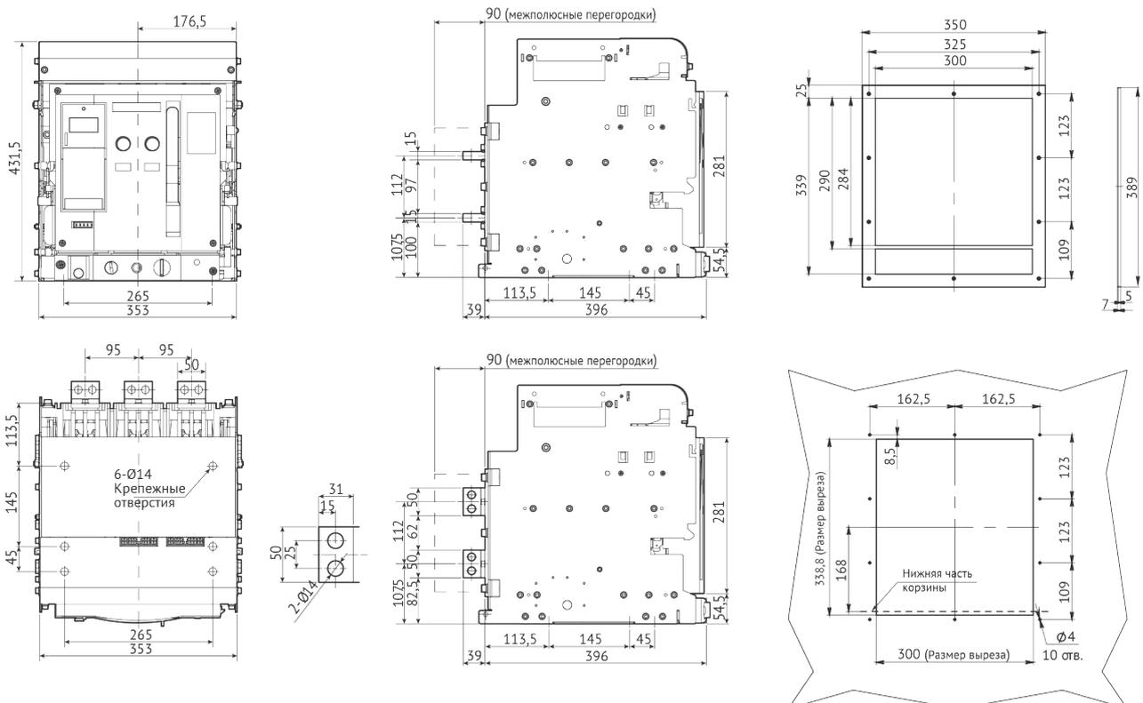
Автоматический выключатель "YON" AD-630-1600-S2-4P выдвигного исполнения на номинальные токи 630-1600 А с задним вертикальным и горизонтальным расположением выводов
