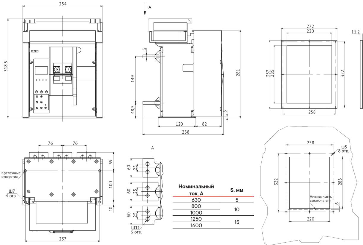
Автоматический выключатель "YON" AD-1600-S1-3P стационарного исполнения на номинальный ток 1600 А с задним горизонтальным расположением выводов с установленными расширителями полюсов
