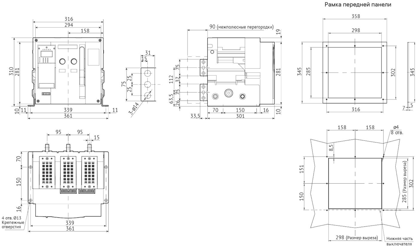
Автоматический выключатель "YON" AD-2000-S2-4P стационарного исполнения на номинальный ток 2000 А с задним вертикальным и горизонтальным расположением выводов
