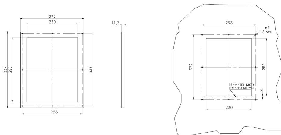
Рамка передней панели стационарного "YON" AD габаритного размера S1 на токи от 630 до 1600 А
