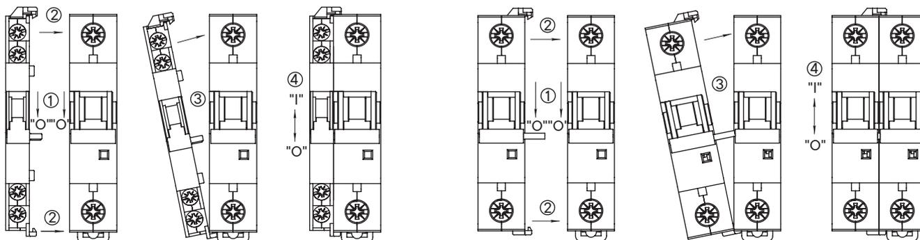
Присоединение модулей со вспомогательными контактами к выключателю или к модулю с независимым расцепителем
