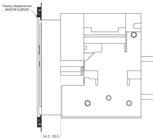
S2 S4 стационарного типа с установленной рамкой (вид сбоку)
