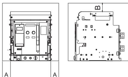
В таблице указано минимально допустимое расстояние между автоматическим воздушным выключателем и металлическими частями распределительного устройства.
