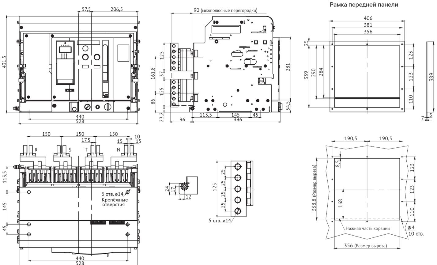
Автоматический выключатель YON AD-5000-6300-S6-3P выдвижного исполнения на номинальный ток 5000-6300 А вертикального присоединения
