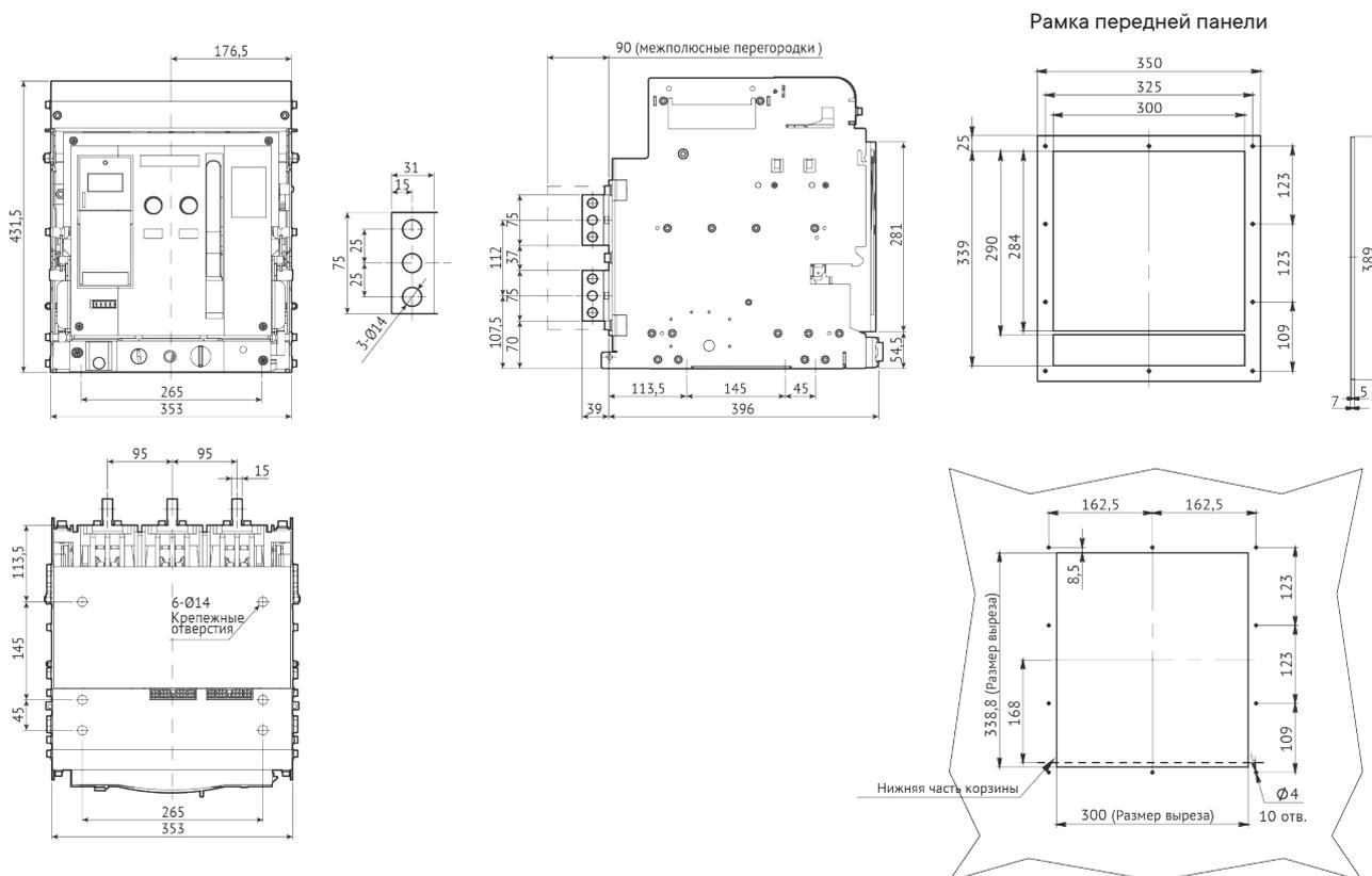
Автоматический выключатель "YON" AD-2000-S2-4P выдвижного исполнения на номинальный ток 2000 А с задним вертикальным расположением выводов
