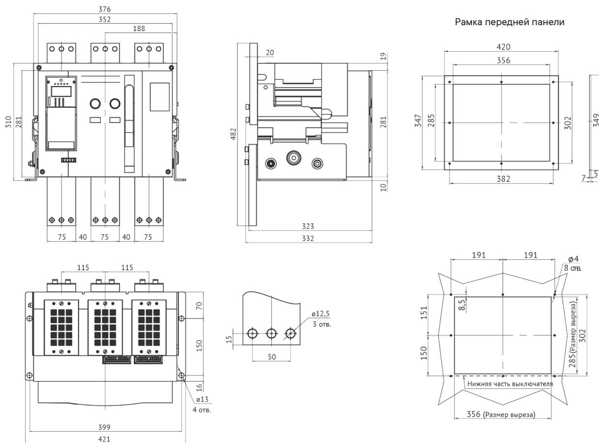
Автоматический выключатель "YON" AD-2500-S4-4P стационарного исполнения на номинальный ток 2500 А с передним расположением выводов
