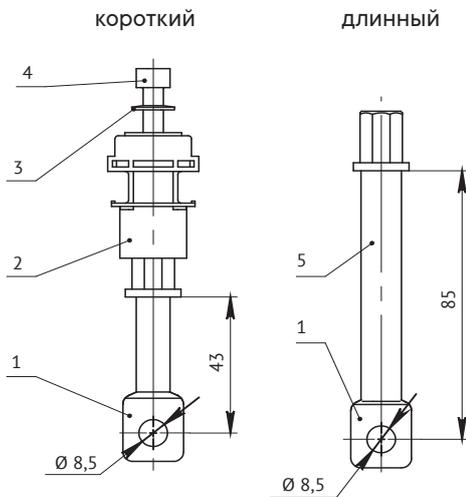
1 - вывод; 2 - переходная деталь; 3 - пружина тарельчатая;
