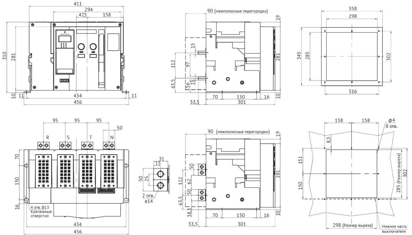
Автоматический выключатель "YON" AD-2000-S2-3P стационарного исполнения на номинальный ток 2000 А с задним вертикальным расположением выводов
