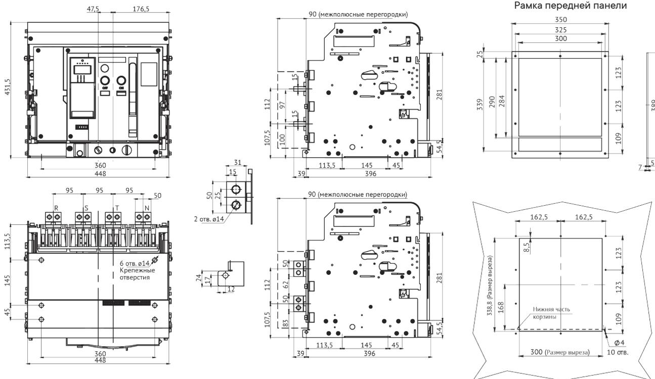
Автоматический выключатель "YON" AD-2000-S2-3P выдвигного исполнения на номинальный ток 2000 А с задним вертикальным расположением выводов
